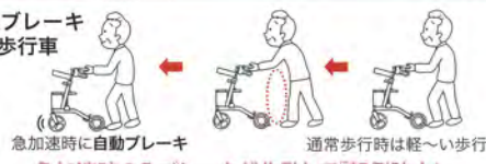
抑速機構を小型化し、車輪に内蔵。バッテリーなどの電源は一切不要。
